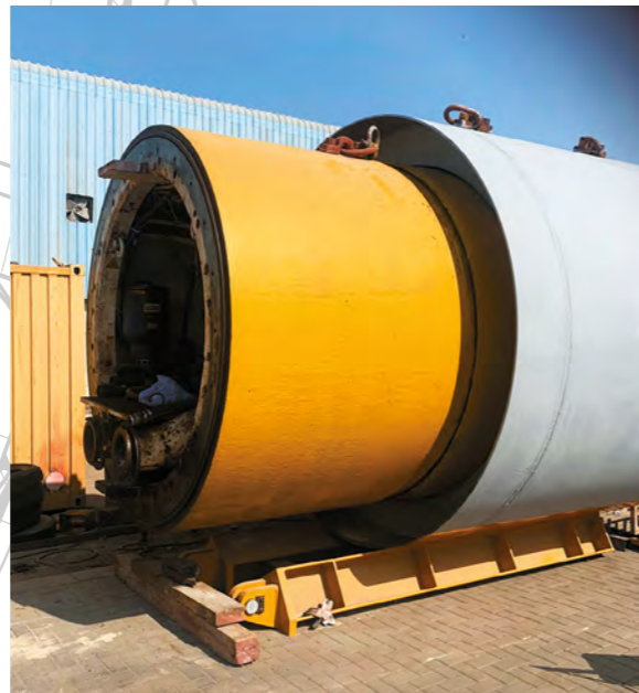
Aufgedoppelte MTBM / Upsized MTBM
